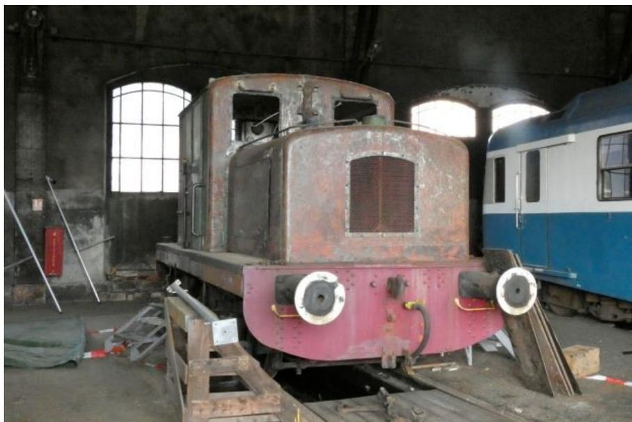
Les travaux de ponçage se poursuivent, de grosses reprises de carrosserie sont prévues sur le tablier et le pourtour des glaces suite à corrosion profonde. Dans les prochaines semaines, il est prévu un redémarrage du moteur.
