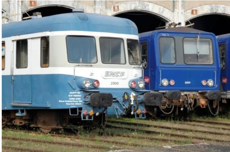
Suite au train du 11 septembre à destination de LaBourboule, La rame composée du X2900, X2230, XR6233 et XR6239 fait l'objet de remises à niveaux pour des défauts constatés lors de cette sortie, en particulier la distribution d'eau dans les toilettes, la vérification de la fermeture des portes, la sonorisation d'une partie de la salle voyageurs de la remorque XR6233.
