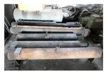
**Moyse**: Les réservoirs d'air déposés font l'objet d'un dossier auprès de la société Le Réservoir en vue de leur remplacement. Les travaux de ponçage se poursuivent.
