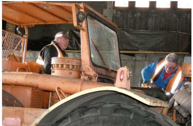
Sur la grue, les travaux de remise en état des vérins se poursuivent. Prochainement les vérins des bogies seront déposés.
