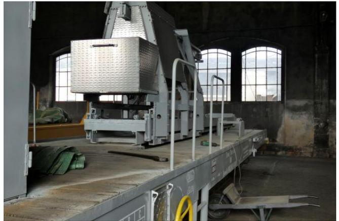
Chantier peinture en cours, le porte CR8 après ponçage du plancher a reçu une couche d'apprêt, le wagon de manutention des rampes, a fait l'objet de reprises peinture au niveau du plancher.
