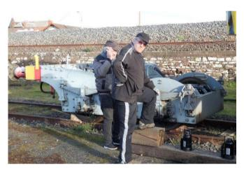
La remise en état du circuit hydraulique se poursuit, les vérins de calage déjà déposés font l'objet d'un nettoyage minutieux en attendant le remplacement des joints.
