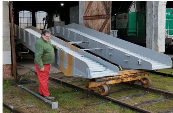
Le ponçage du plancher se termine, place à la peinture, les rampes ont été à nouveau grattées une nouvelle couche d'apprêt appliquée la couche grise de finition est en cours. Les faces latérales du châssis sont déjà apprêtées.
