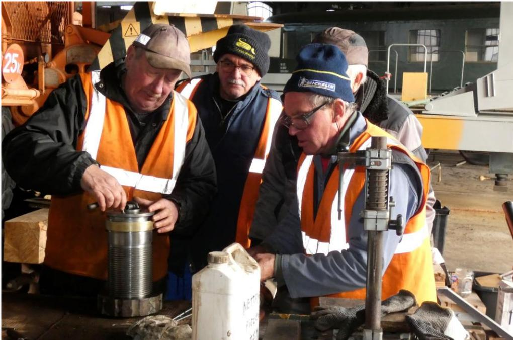
Remise en état des vérins de calage de la grue, ceux situés sur châssis et bras : nettoyage, contrôle et stockage en attente de joints neufs.
