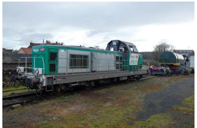
Manœuvre du wagon porte flèche et sortie de la voie de stationnement de la grue de son 1<sup>er</sup> bogie de transport. Cette manœuvre est rendue nécessaire pour la dépose du vérin centrale sur fosse.
