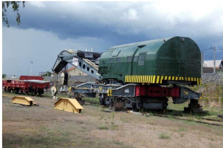
La grue a été remise en service le mardi 16 pour un contrôle de bon fonctionnement en vue de l'arrivée prochaine du wagon G40 entrant dans la composition du train de secours. Les différents mouvements ont été testés, le résultat est satisfaisant.
