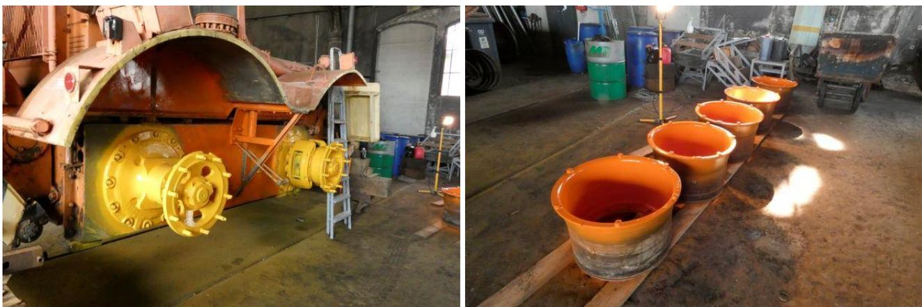
Cet engin a fait l'objet d'un passage appuyé au nettoyeur à pression chauffant afin de pouvoir bénéficier, après ponçage, d'une mise en peinture des jantes et moyeux de roue.
