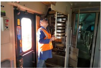
Après la fin de saison 2021, les cinq autorails autorisés à circuler sur le RFN font l'objet de vérifications et de remises en état préparatoires à la prochaine saison : charges batteries et démarrages réguliers, analyse de disfonctionnement sur la signalisation fermeture portes des X2200, dépose distributeur de freinage pour passage au banc aux ateliers de Rennes sur X2232, élaboration du planning des visites 2022.
