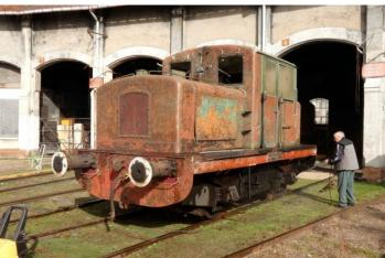
Profitant des premiers rayons de soleil de cette année, le Moyse est sortie de sa réserve pour toilettage à l'eau chaude. Le ponçage de la caisse se termine, certaines tôles de capotage ont déjà reçues une première couche d'apprêt, des tôles sur les flancs de châssis seront prochainement soudées pour parfaire l'état de surface avant peinture. Le moteur est maintenant remis en marche régulièrement.
