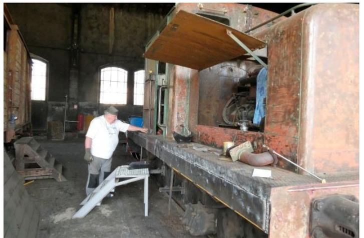
Poursuite des travaux de remise en état des flancs de tablier, soudage plaques sur les deux cotés de l'engin.
