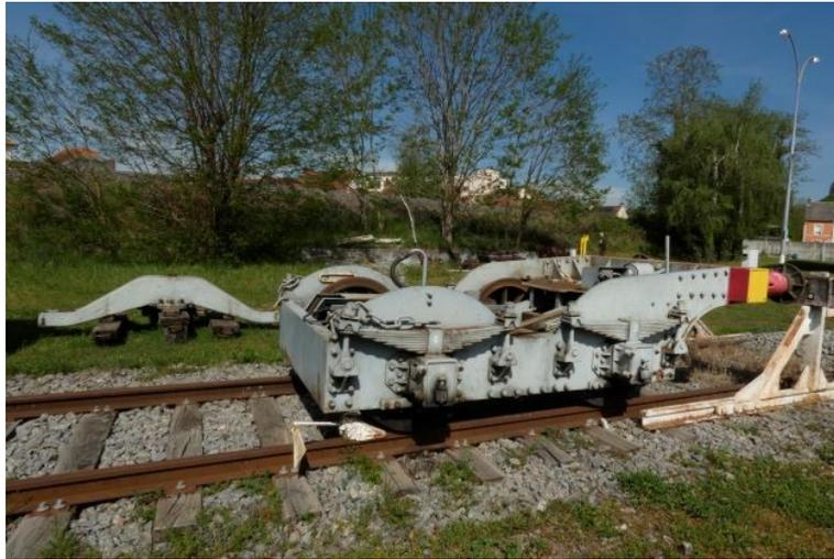
Hydraulique de la grue : le chapeau de gendarme a été déposé sur un des bogies porteurs pour accès et dépose du vérin central en vue de sa remise en état (changement joints). Les vérins de bras sur le châssis de la grue seront quant à eux, remontés prochainement.
