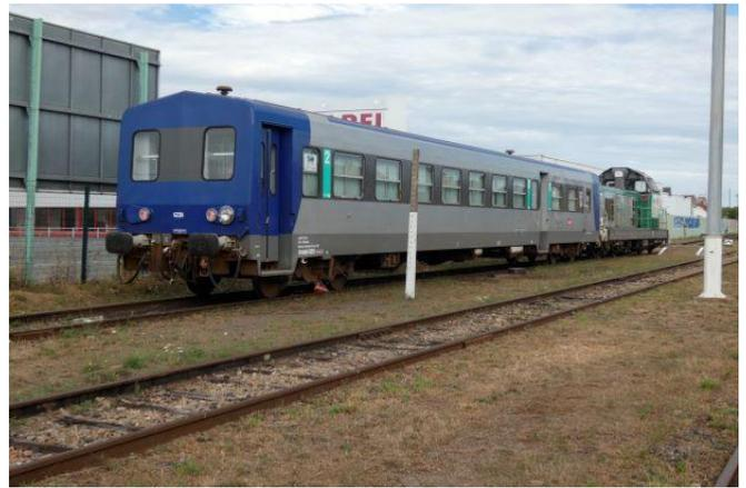
Suite aux visites annuelles réalisées cet été, les travaux de remise en conformité se poursuivent, à ce jour deux matériels sont indisponibles à la circulation sur RFN, il s'agit du X2230 ou le compresseur d'air doit être remplacé et la XR6239 ou un distributeur de frein est déposé pour réglage en technicentre SNCF
