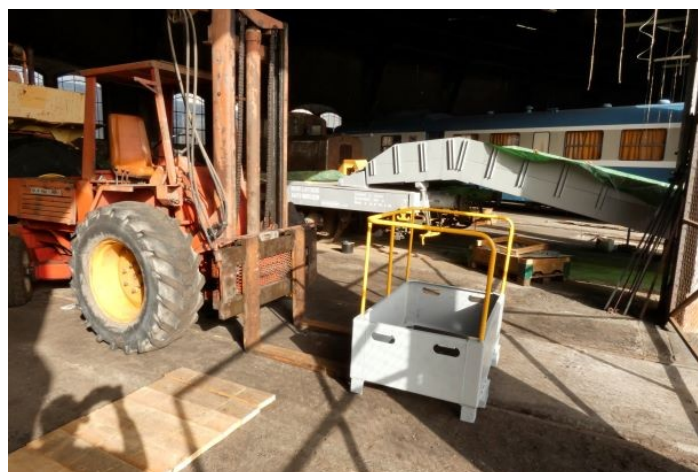
Équipement Manitou : la nacelle de construction intégrale est en cours de finition.
