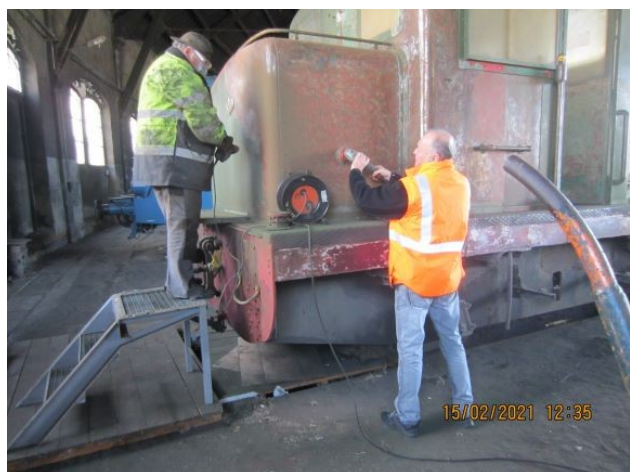
Moyse : les cinq réservoirs d'air sont déposés, les travaux de ponçage sont maintenant bien avancés.
