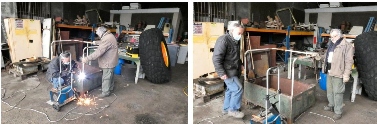
Construction intégrale d'une nacelle de travail pour le chariot élévateur Manitou.
