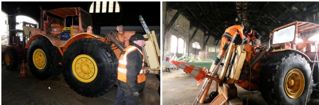
Au Chevet de l'engin pour un redémarrage moteur : Après vérification et remise à niveau des circuits de graissage, de refroidissement et d'alimentation gasoil, le moteur est lancé et tourne à 14 h 50 ce mercredi 27 janvier. Des contrôles et actions correctives sont toutefois nécessaires sur le ralenti moteur mais les résultats de ce jour sont encourageants. Suite aux prochaines séances de travail.
