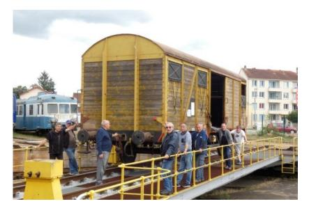
Le wagon d'accompagnement type G40 change de place, il rejoint la partie atelier lourd sous rotonde, le ponçage est en cours sur la caisse et le châssis, préalable à sa remise en peinture.
