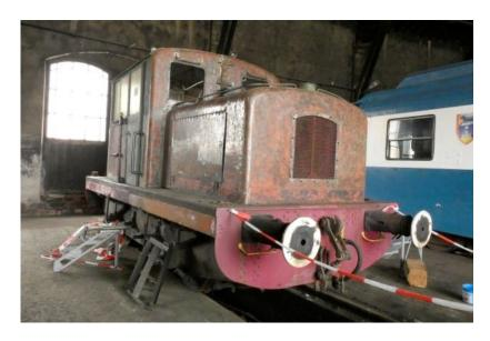
Locotracteur Moyse : les travaux de ponçage de la caisse et du châssis sont en cours, les glaces de la cabine sont en partie déposées, les entourages sont à refaire, encore beaucoup de travail en perspective.
