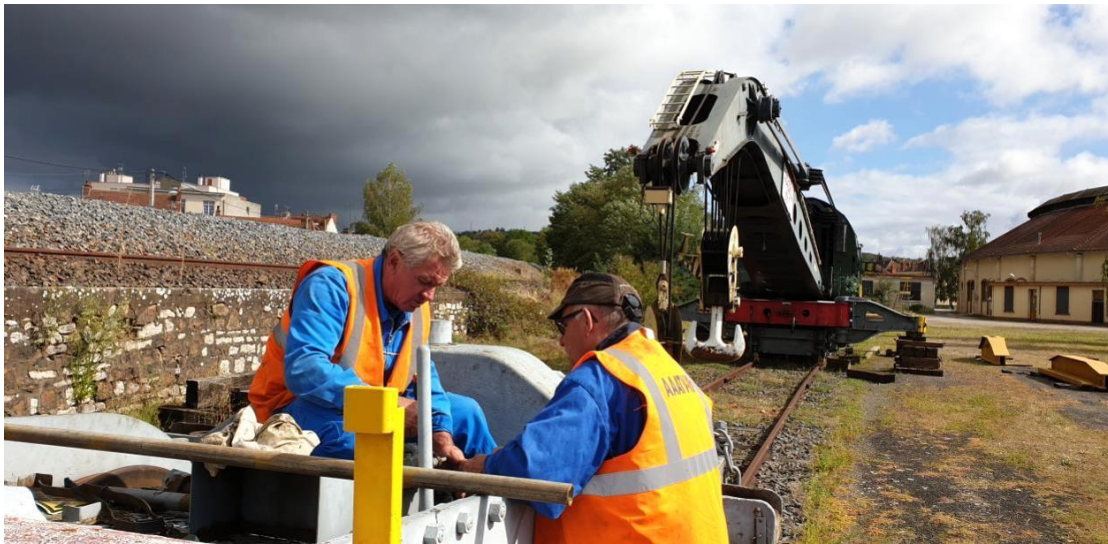
Grue: Remontage des 8 distributeurs (préalablement -et patiemment- entièrement réhabilités par Jean-Jacques dans son atelier personnel ...)
